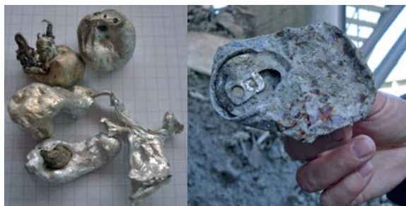
Aluminio fundido y latas recuperadas de las cenizas del horno (foto cortesía de EAA)
